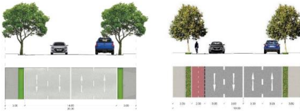
FIGURA 23.6-38: PERFIL EXISTENTE Y PROPUESTO AVDA. SAN VICENTE
